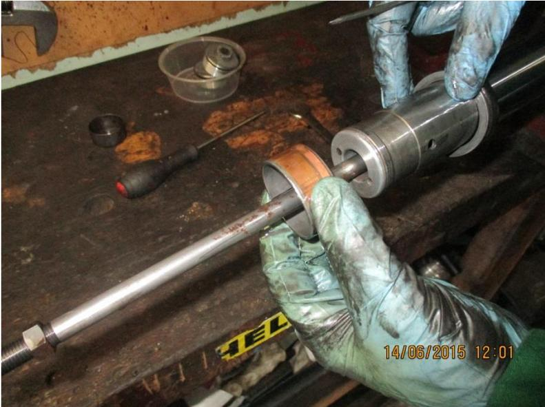
8 - remplacer le joint spi dimensions 41\*53\*8/9.5
