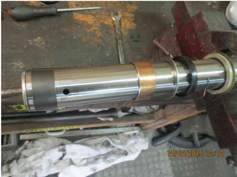
7 – démontage et remplacement des bagues de coulissement
