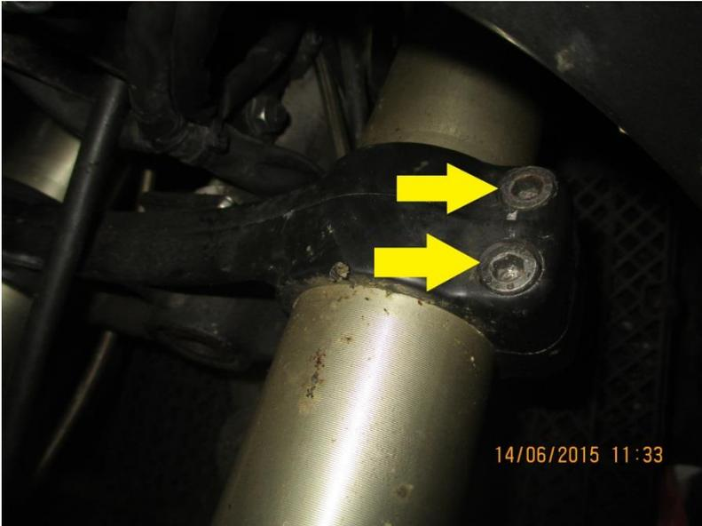
Ca y est la fourche est démontée (attention les bouchons sont desserrés, risque de fuite !)
